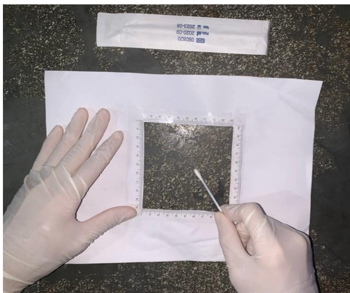
Figura 3 – A imagem representa a área de contato de fricção do swab nas superfícies.
