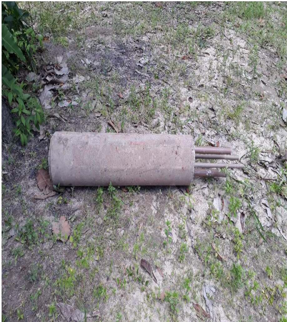
Figura 11 – Tubo de concreto de 200mm com os canos de PVC Fonte: O autor, 2018
