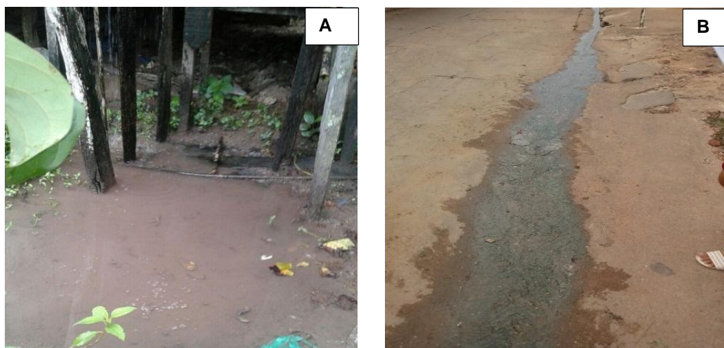
Figura 19 – (A) Esgoto de pia no quintal de uma residência; e (B) Esgoto de chuveiros despejado em via pública na cidade de Óbidos, Pará, Brasil. (Fonte: Próprio autor).
