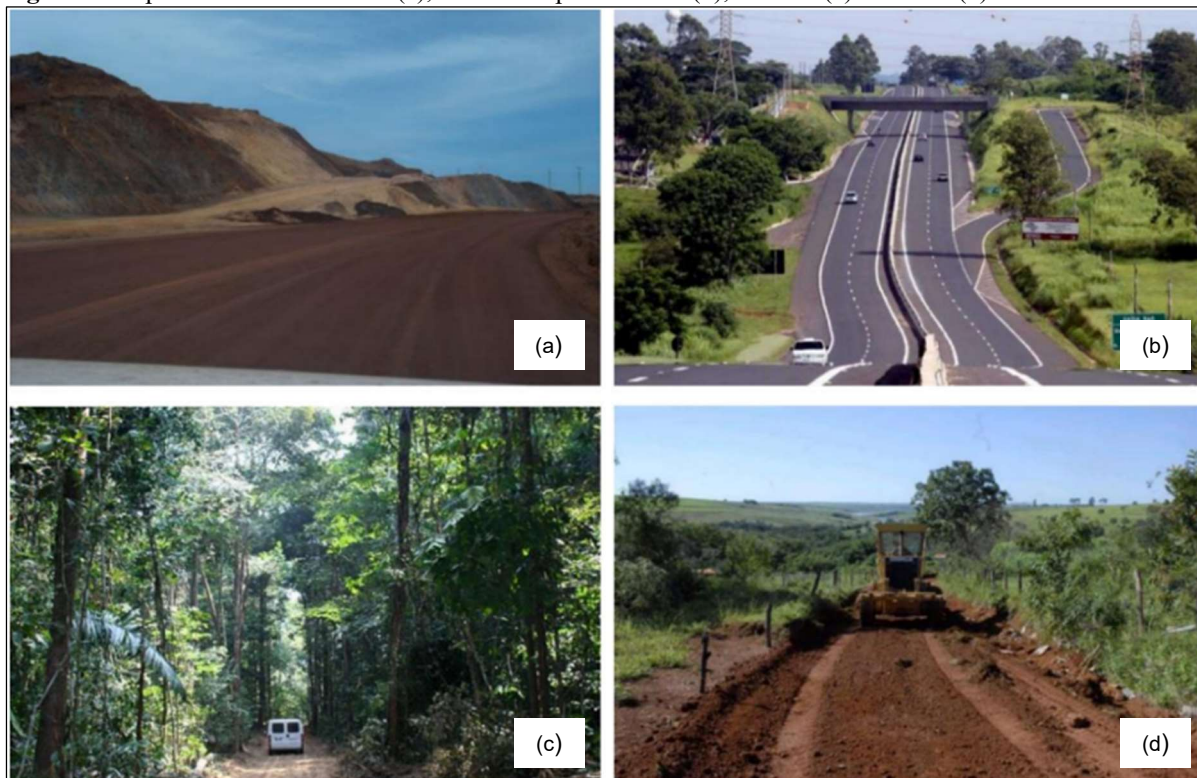
Figura 2 - Tipos de estrada de: mina(a), rodoviária pavimentada(b), florestal(c) e vicinal (d)
