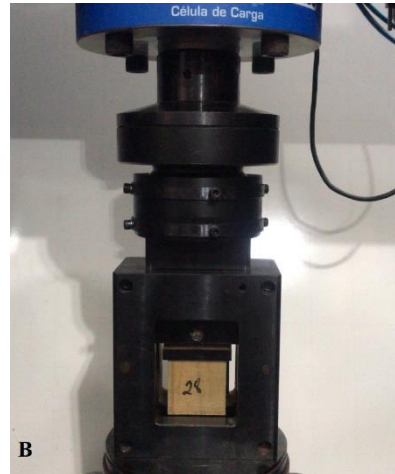
Figura 1. A. Corpo de prova e dimensões adotadas pela norma para ensaio de cisalhamento (espessura 19 mm x largura 50,8 mm x comprimento 44,5 mm). B. Dispositivo de ensaio. Fonte: ASTM D905.
