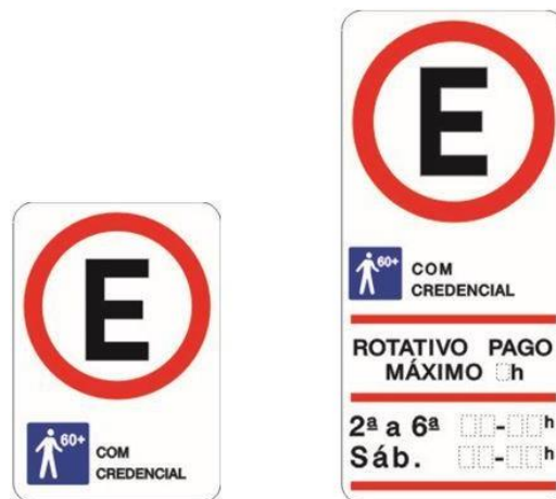
Figura 5 — Sinalização Vertical de Regulamentação de vaga exclusiva de estacionamento para pessoas idosas
