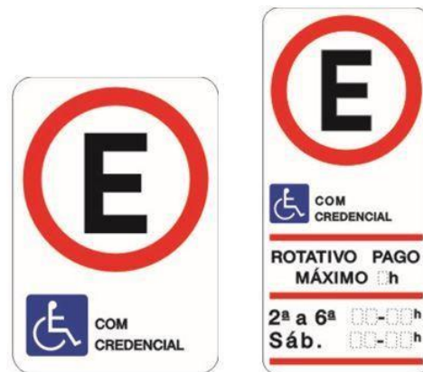
Figura 4 – Sinalização Vertical de Regulamentação de vaga exclusiva de estacionamento para PcDs
