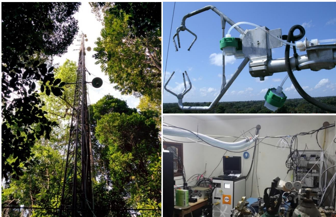
Figura 9 – Sítio experimental de pesquisa localizado na Flona do Tapajós: (a) torre de fluxo; (b) anemômetro sônico 3-D Campbell CSAT-3, com destaque à entrada das amostras acoplada ao equipamento; (c) interior do abrigo com os equipamentos conectados ao tubo de transferência das amostras para o PTR-ToF-MS.
