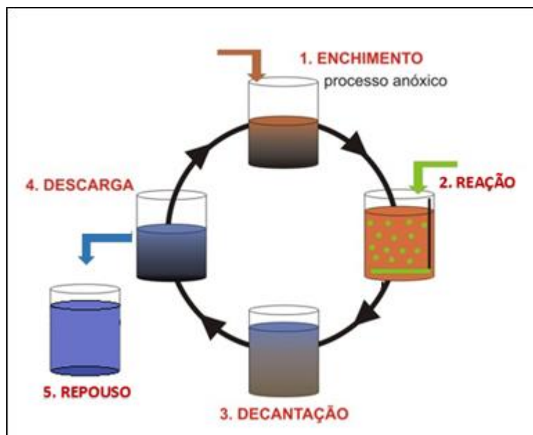
Figura 3: Ciclo de Funcionamento do Reator em Bateladas Sequenciais
