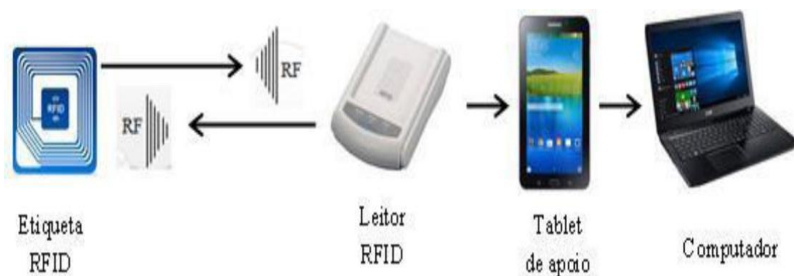
Figura 09 - Componentes do sistema RFID
