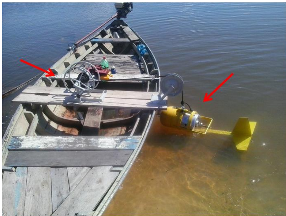
Figura 3 – Embarcação com sistema de guincho para imersão e emersão do amostrador de sedimento de saca (AMS-08) utilizado para coleta de sedimentos em suspensão.
