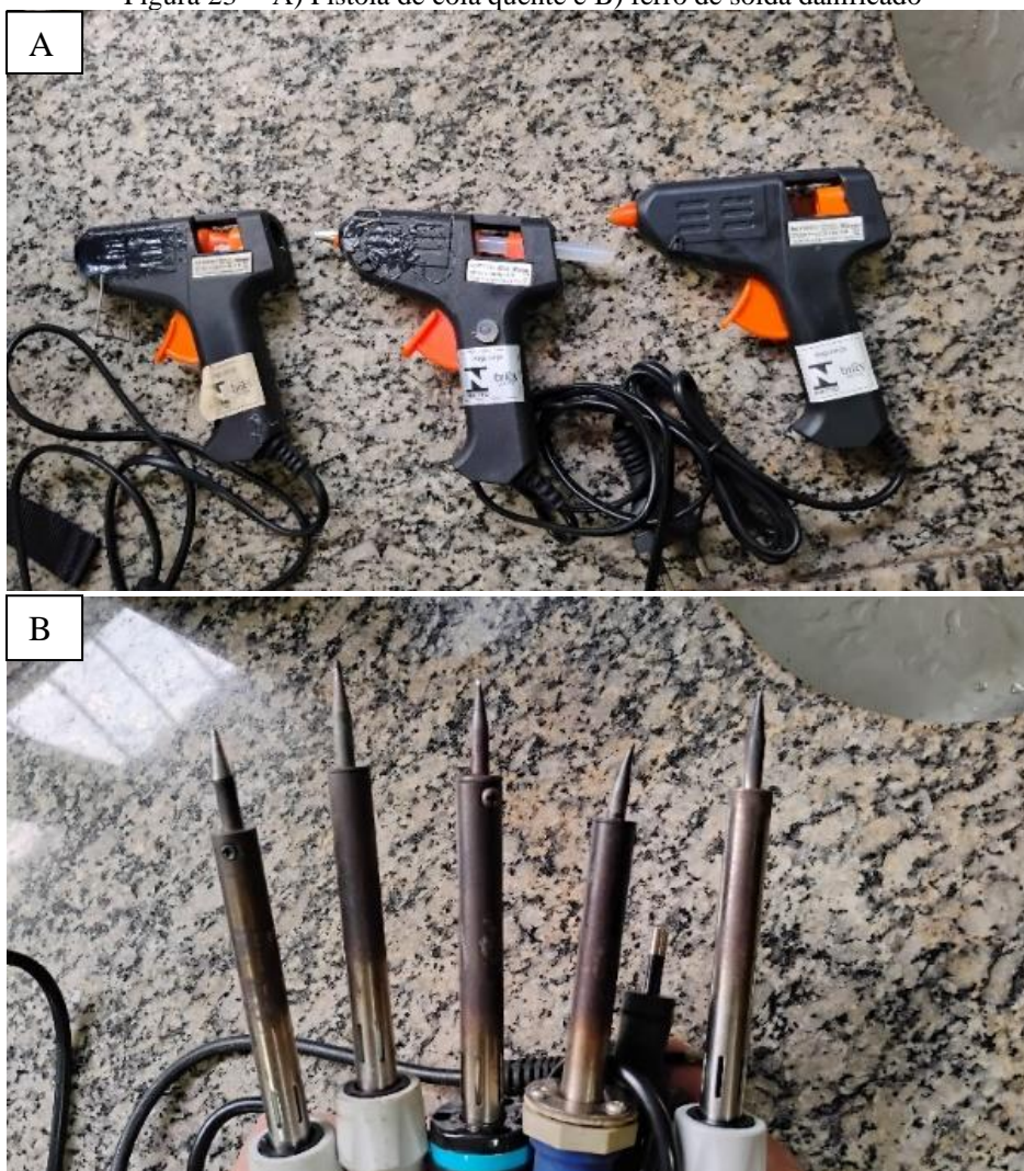
Figura 23 — A) Pistola de cola quente e B) ferro de solda danificado
