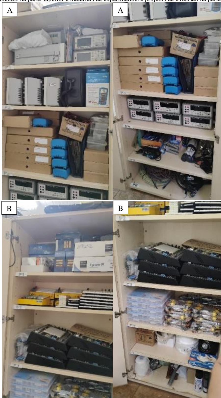
Figura 15 - Armários após a aplicação do 5S, com os materiais organizados e armazenados por afinidade: AA) separados os materiais mais utilizados nas práticas de aula; BB) kits de experimentos de eletrônica; CC) materiais diversos, como ferramentas de informática e insumos para impressoras 3D; DD) manuais de equipamentos na parte superior e materiais de experimentos e projetos de extensão na parte inferior.
