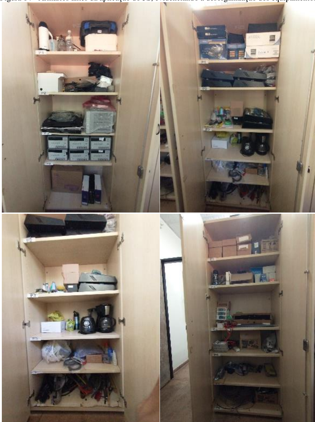
Figura 14 - Armários antes da aplicação do 5S, evidenciando a desorganização dos equipamentos.
