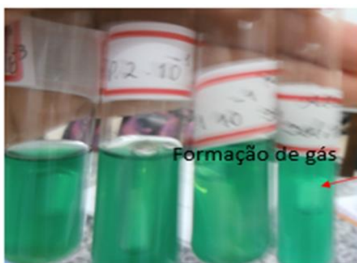
Figura 9: Tubos positivos para CT para amostra de água e areia da praia do Maracanã, Santarém-PA.
