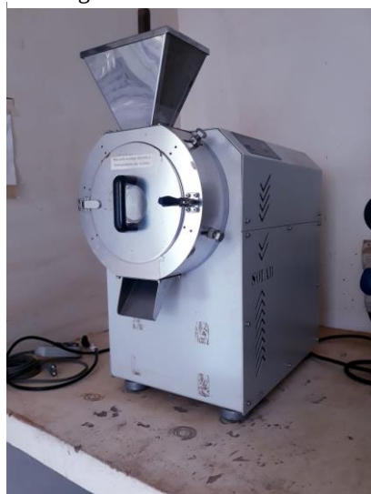
Figura 14 – Moinho de facas utilizado na moagem das amostras.
