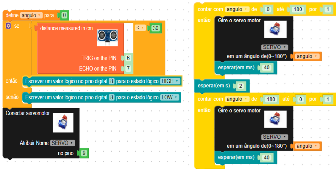
Figura 8 – a) Atribuição do sensor e servo e b) loop de giro.
