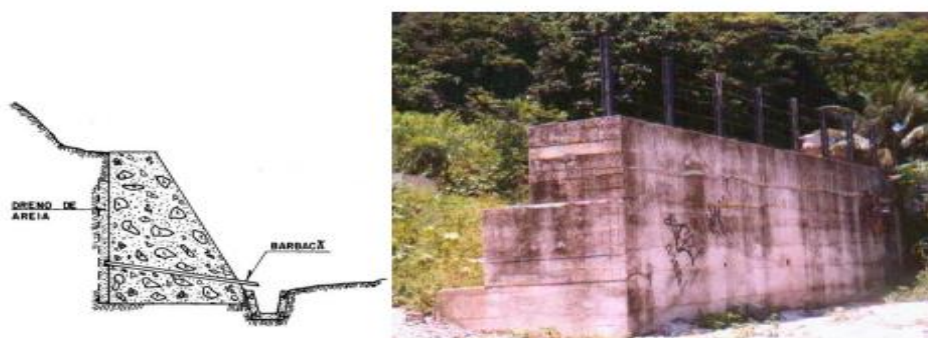
Figura 9 - Muros de concreto ciclópico (ou concreto gravidade).
