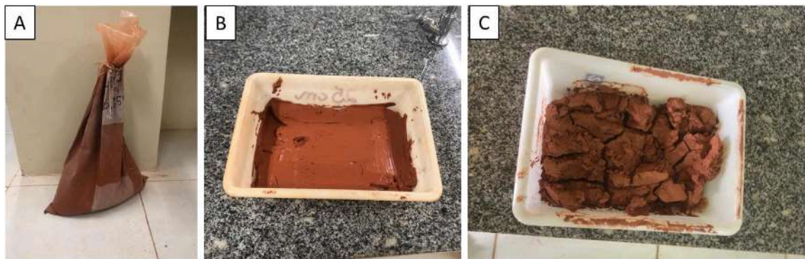
Figura 07 - Processo de homogeneização e secagem da amostra: Homogeneização e retirada de porção da amostra (A), Amostra distribuída em camada fina no interior do recipiente plástico (B) e Fração sólida da amostra resultante do processo de evaporação (C)
