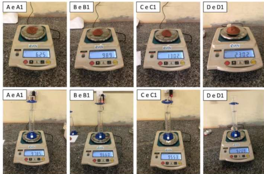
Figura 12 - Preparação das polpas para ensaio de sedimentação: Teor de 6% (A1 e B1), Teor de 9% (B e B1), Teor de 12% (C e C1) e Teor de 20% (D e D1)
