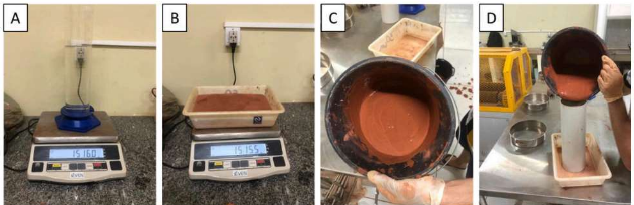
Figura 16 - Preparação das polpas para ensaio de consolidação mecânica: Pesagem da fração líquida (A), Pesagem da fração sólida (B), Homogeneização das frações (C) e Inserção no protótipo (D).
