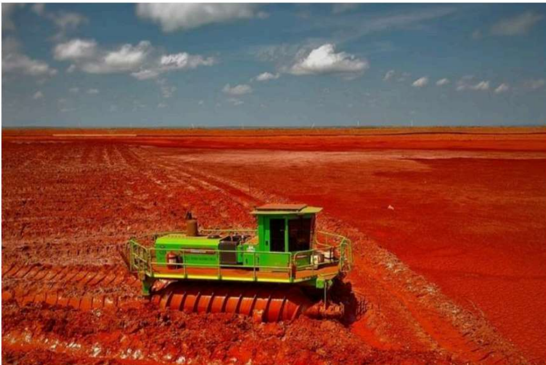
Figura 05 – Máquina de propulsão por parafuso e flutuante MudMaster - Phibion.
