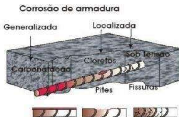
Figura 1- Corrosão de armadura
