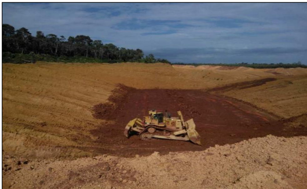
Figura 16 - Trator D11 sobre a tira de minério após ter removido o estéril
