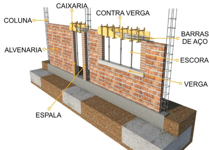
Figura 3 – Etapas construtivas da alvenaria convencional
