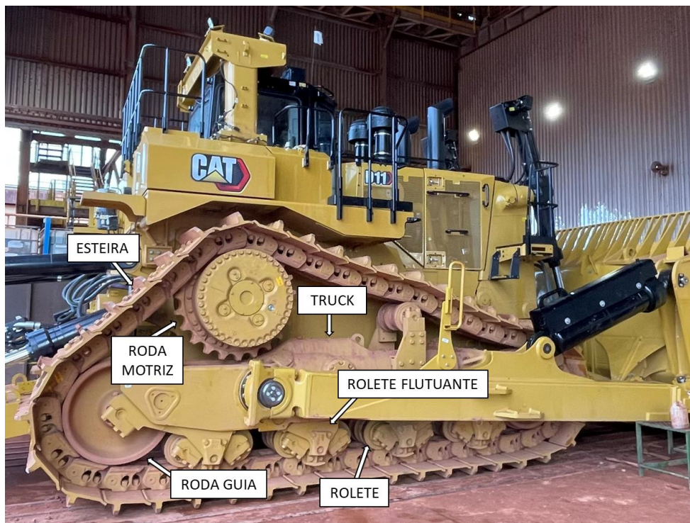
Figura 5: Componentes do sistema de locomoção do trator D11
