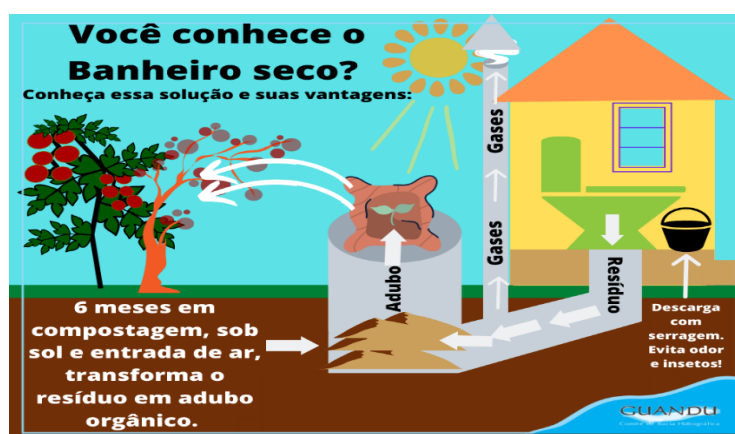
Figura 3: Explicação do formato de banheiro seco
