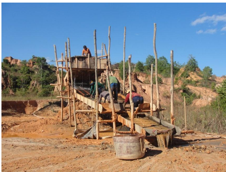
Figura 16 Momento da despescagem da “caixa”, o equipamento utilizado no processamento do ouro mandado dos barrancos pela maraca.
