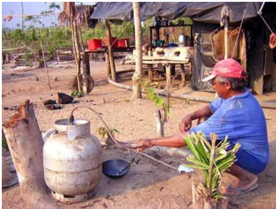
Figura 14 Processo da queima do ouro para o separar do mercúrio.
