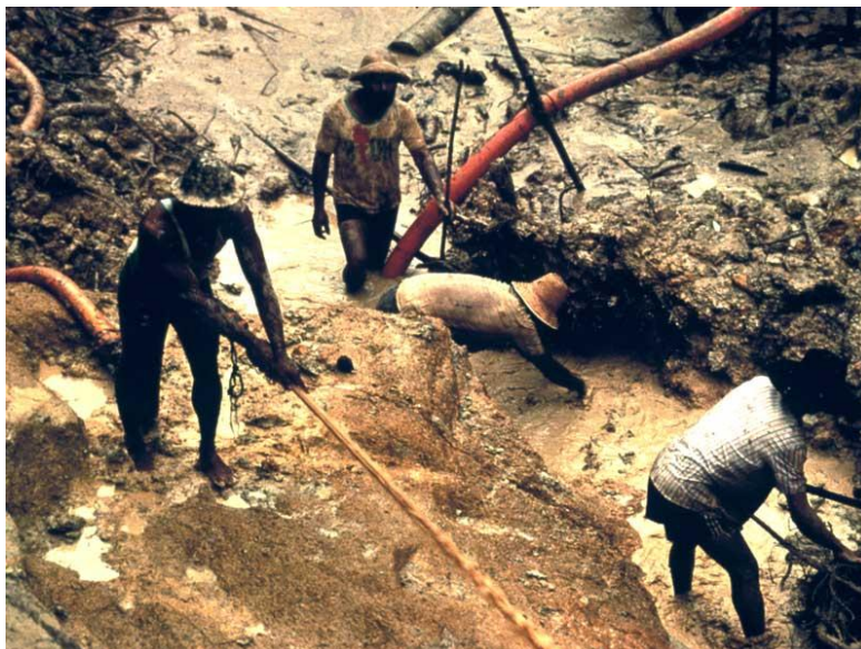
Figura 15 Garimpagem semimecanizada. Um trabalhador no bico jato, um operando a maraca e outros dois na limpeza do barranco.
