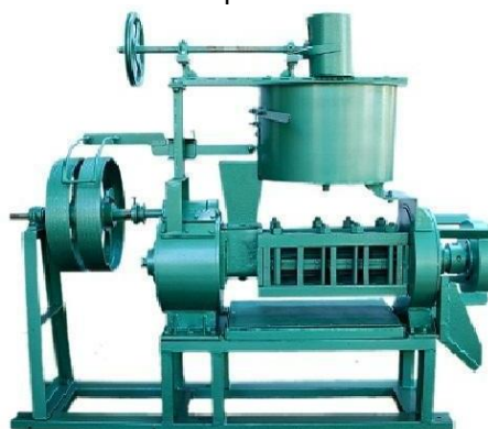
Figura 5 - Imagem ilustrativa de uma máquina extratora de óleo de andiroba “ expeller ”.
