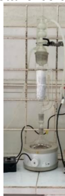
Figura 14 - Obtenção do extrato etanólico do resíduo da andiroba em soxhlet.
