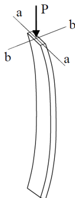
Figura 5 – Flambagem na direção da largura da coluna de seção retangular.
