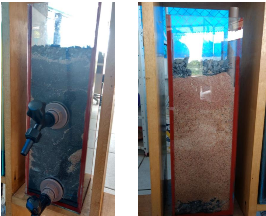
Figura 10 - Reator de Bancada – Filtro Biológico Percolador.
