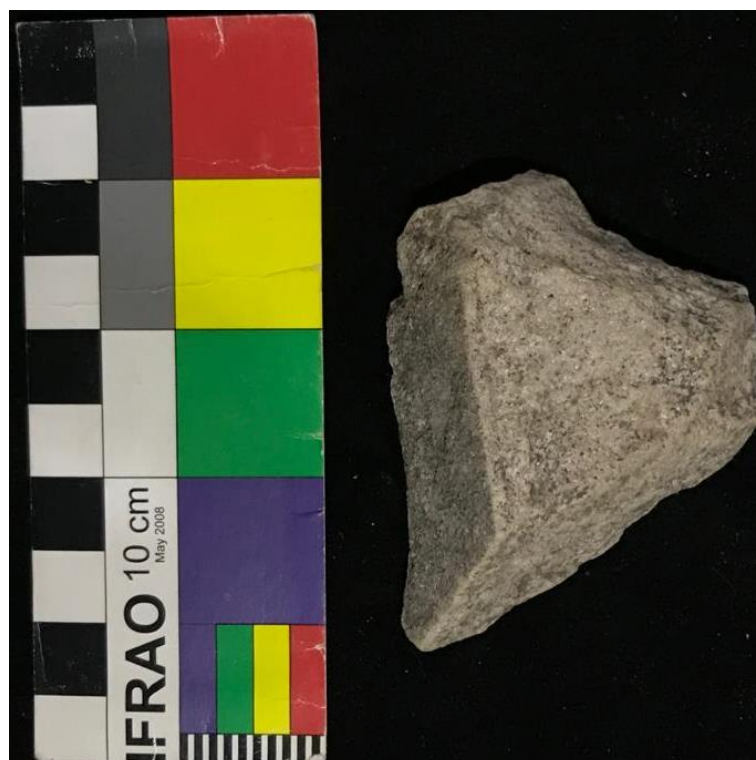
Figura 42: Bloco de arenito utilizado no experimento de corte
