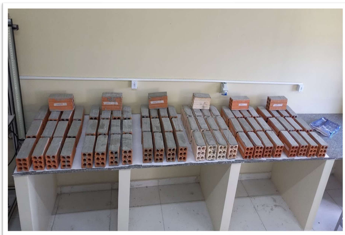
Figura 31 - Tijolos recapeados com argamassa para realização de ensaios de compressão.
