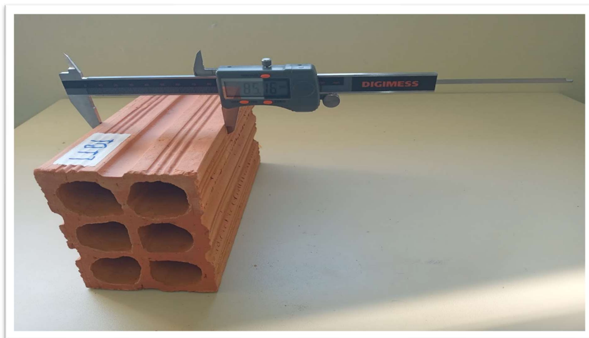
Figura 26 - Características geométricas – medição de largura para encontrar a área bruta dos tijolos.
