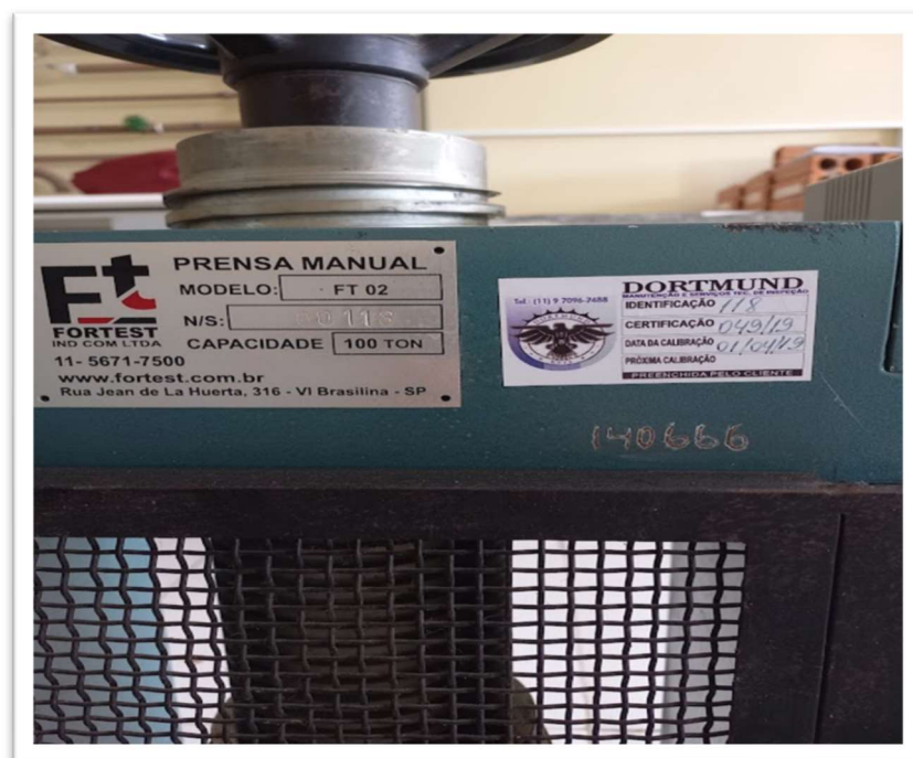
Figura 32 - Prensa hidráulica manual capacidade 100 t/f.
