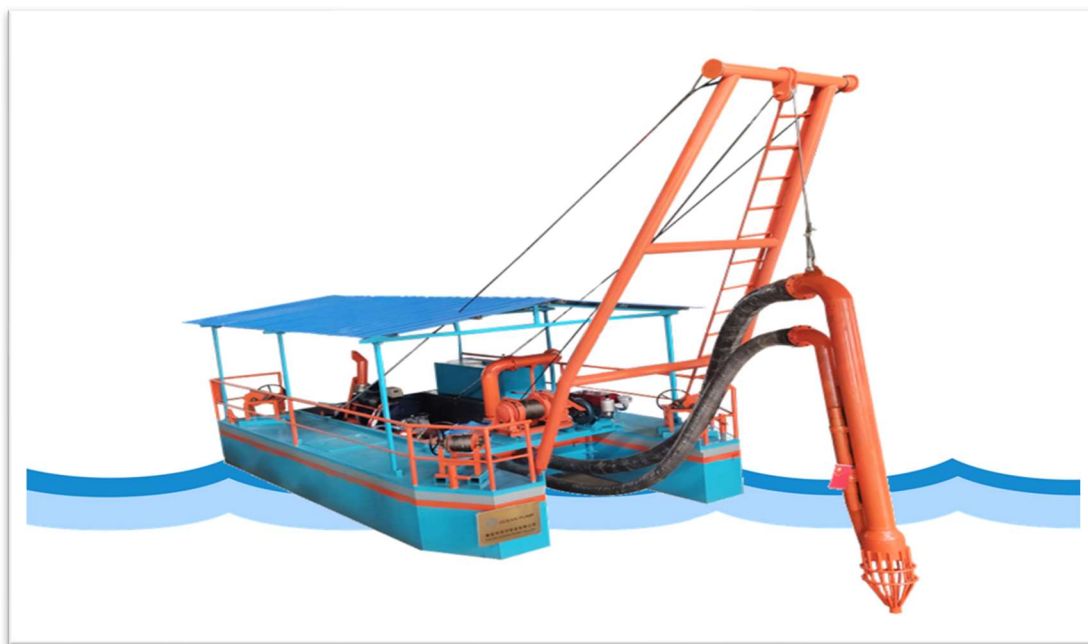
Figura 2 - Draga de sucção usada em pláceres inundados.
