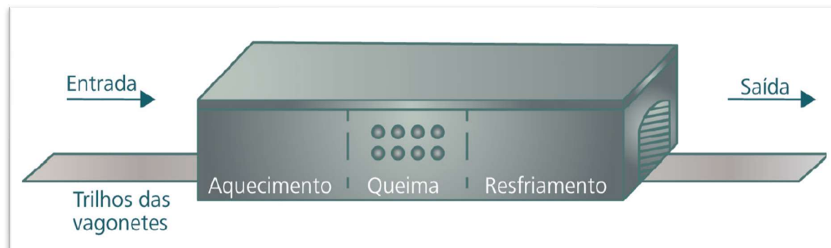
Figura 9 - Esquema de seção transversal longitudinal de um forno contínuo tipo túnel.
