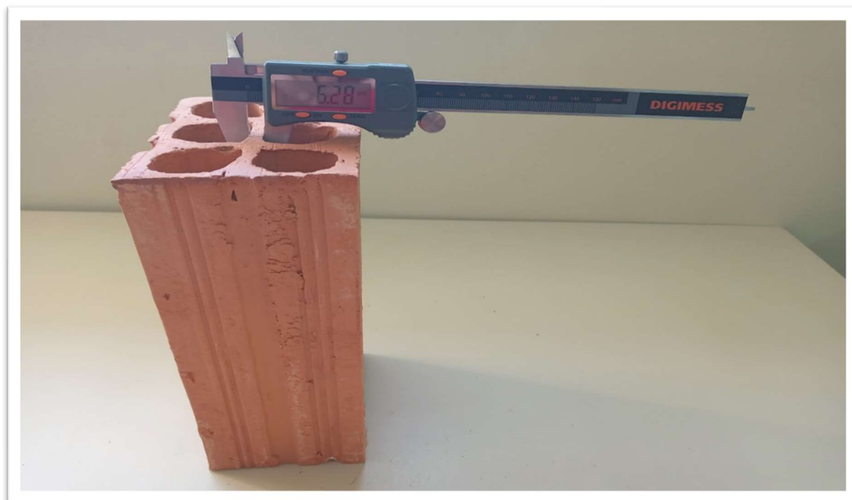
Figura 25 - Características geométricas – medição da espessura dos septos dos tijolos.
