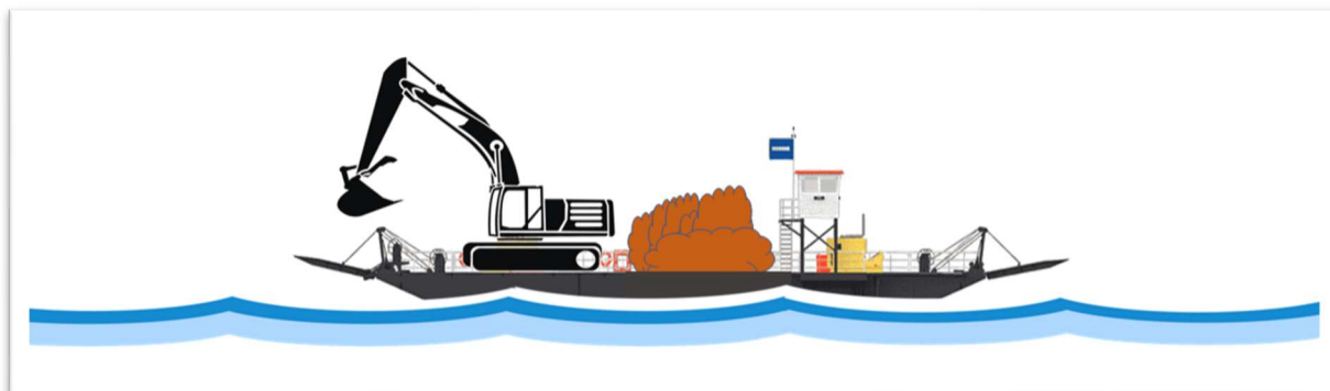
Figura 33 - Representação esquemática do processo de exploração da argila para a fabricação de tijolos.
