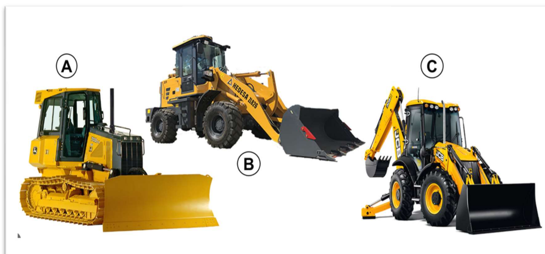
Figura 1 - Principais equipamentos de corte e carregamento usados em locais a seco na lavra de pláceres (A) Trator de esteira; (B) Carregadeira de pneus; (C) Retroescavadeira.
