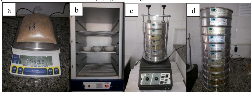
Figura 3.11 - (A) balança de precisão. (B) estufa para a secagem das mostras. (C) conjunto de peneiras usadas da marca Bertel. (D) agitador magnético da marca Bertel.
