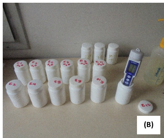
Figura 11: (A) Coleta para análise de pH Fig. (B) Análise de pH e temperatura do efluente e da água de abastecimento usados no sistema.
