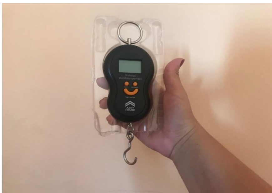
Figura 4: Balança tipo Pêndulo Digital (50kg). Fonte: Autora, 2018.
