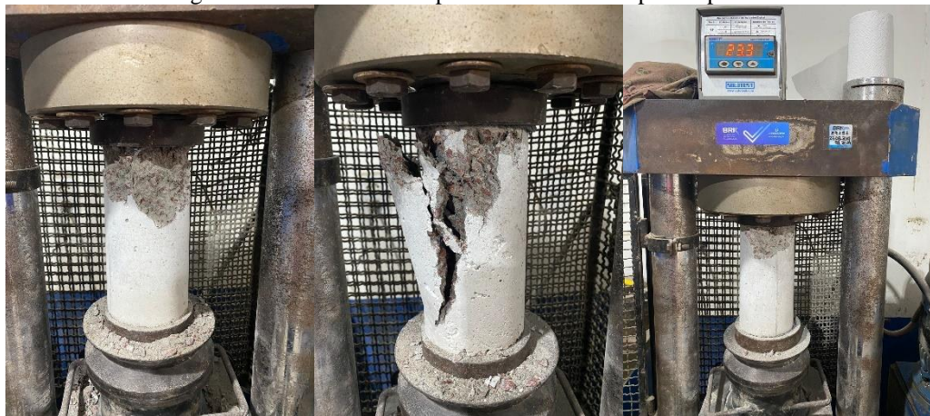
Figura 26 - Ensaios de compressão axial dos corpos de prova.
