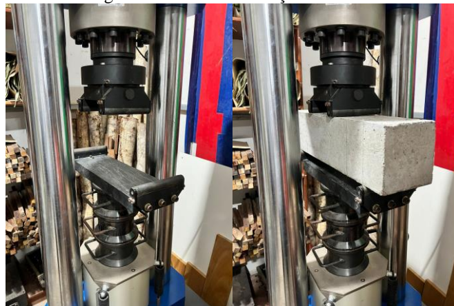
Figura 27 - Ensaio de tração na flexão.
