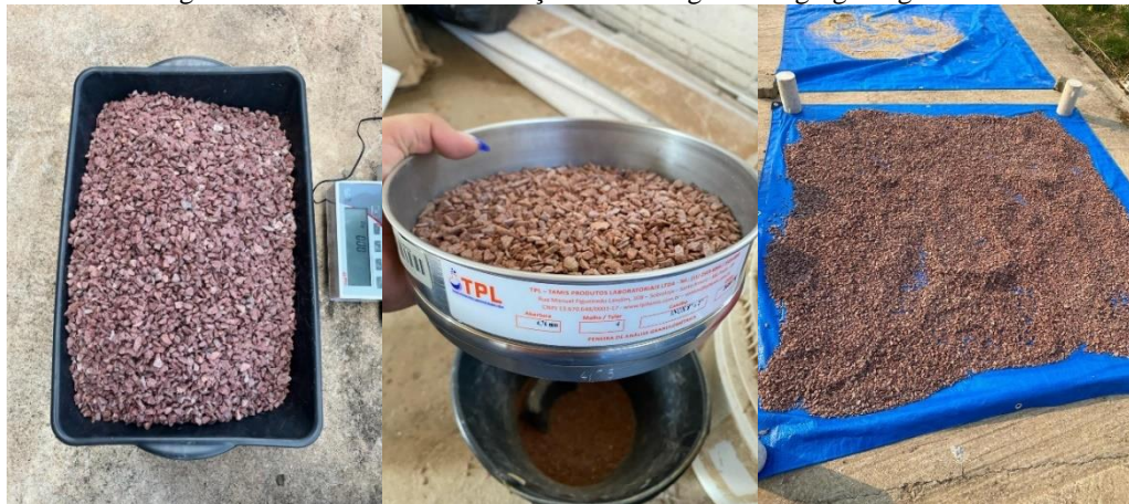
Figura 17 - Processo caracterização e de secagem do agregado graúdo.
