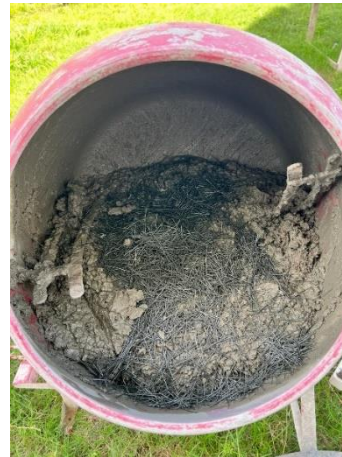
Figura 22 - Preparação do concreto com fibra manual em betoneira.
