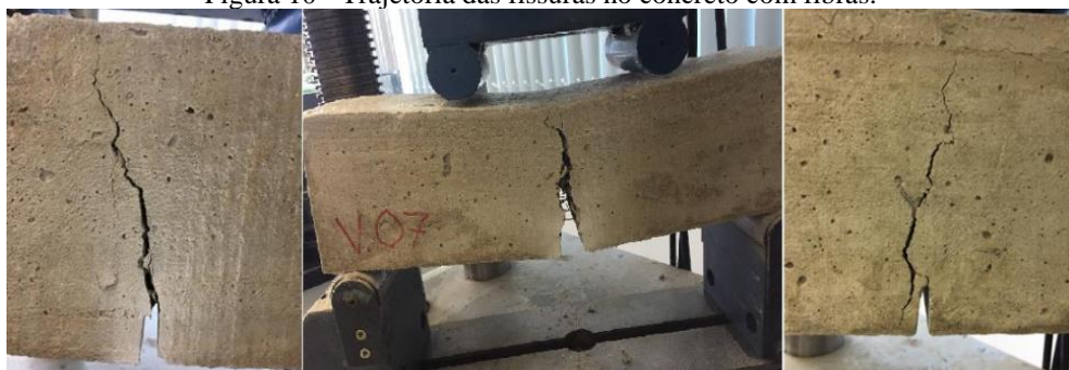
Figura 10- Trajetória das fissuras no concreto com fibras.
