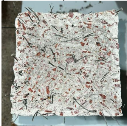
Figura 39 – Distribuição das fibras a 0,45%.
