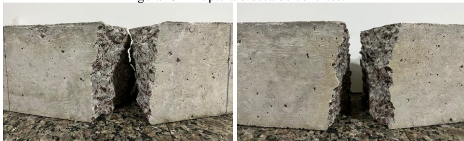
Figura 29 – Ruptura brusca do concreto.
