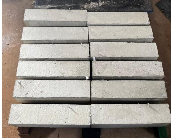
a) Desforma das vigas
