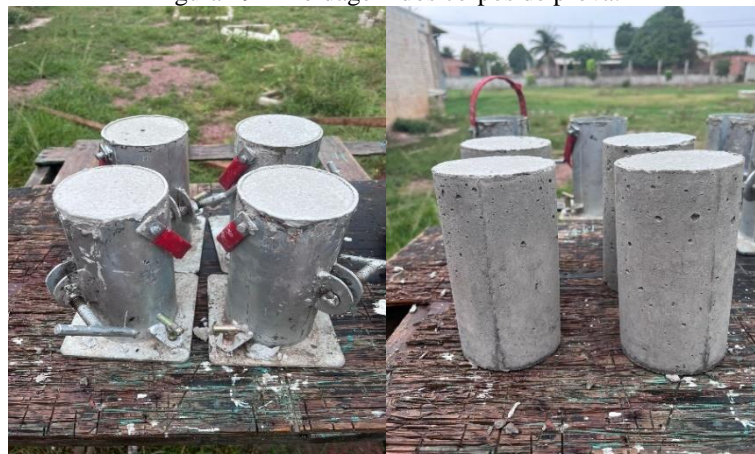
Figura 19 - Moldagem dos corpos de prova.
