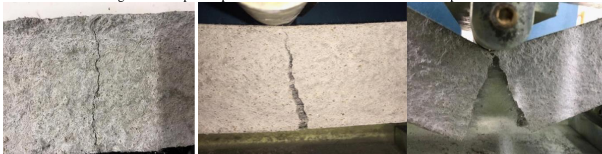
Figura 8 - Corpos de prova em detalhe com fissuras até seu rompimento.
