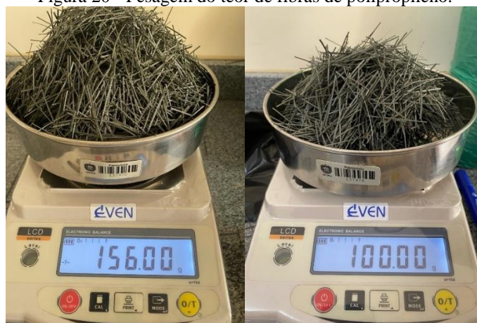
Figura 20 - Pesagem do teor de fibras de polipropileno.
