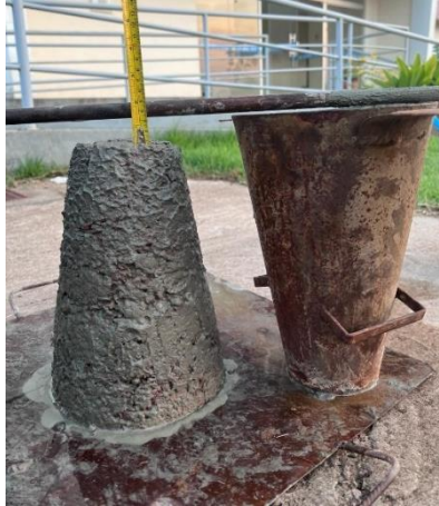
Figura 18 - Consistência e trabalhabilidade (Slump test do Concreto).
