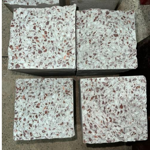
Figura 30 – Qualidade do concreto vigas 0% de fibras.
