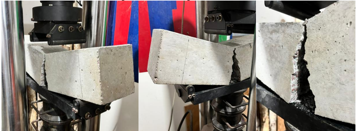
Figura 28 – Ensaios vigas 0% de fibras.
