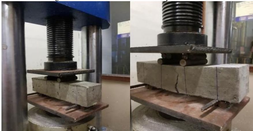
Figura 11 - Ensaio de resistência à tração na flexão.
