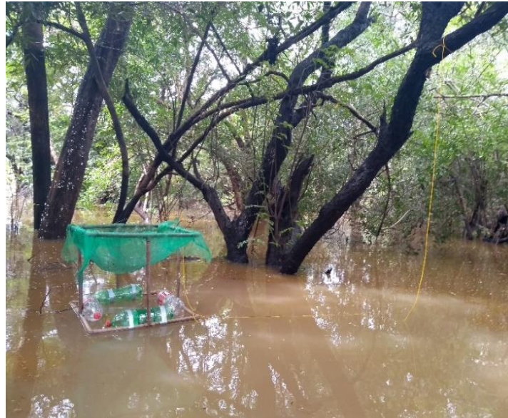
Figura 2 - Modelo de coletor desenvolvido e utilizado na coleta da serapilheira em floresta de Várzea, do presente estudo.
