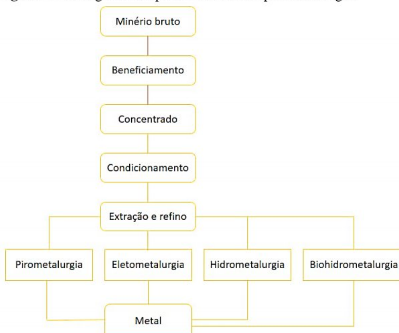
Figura 1 - Fluxograma simplificado das rotas para metalurgia.
