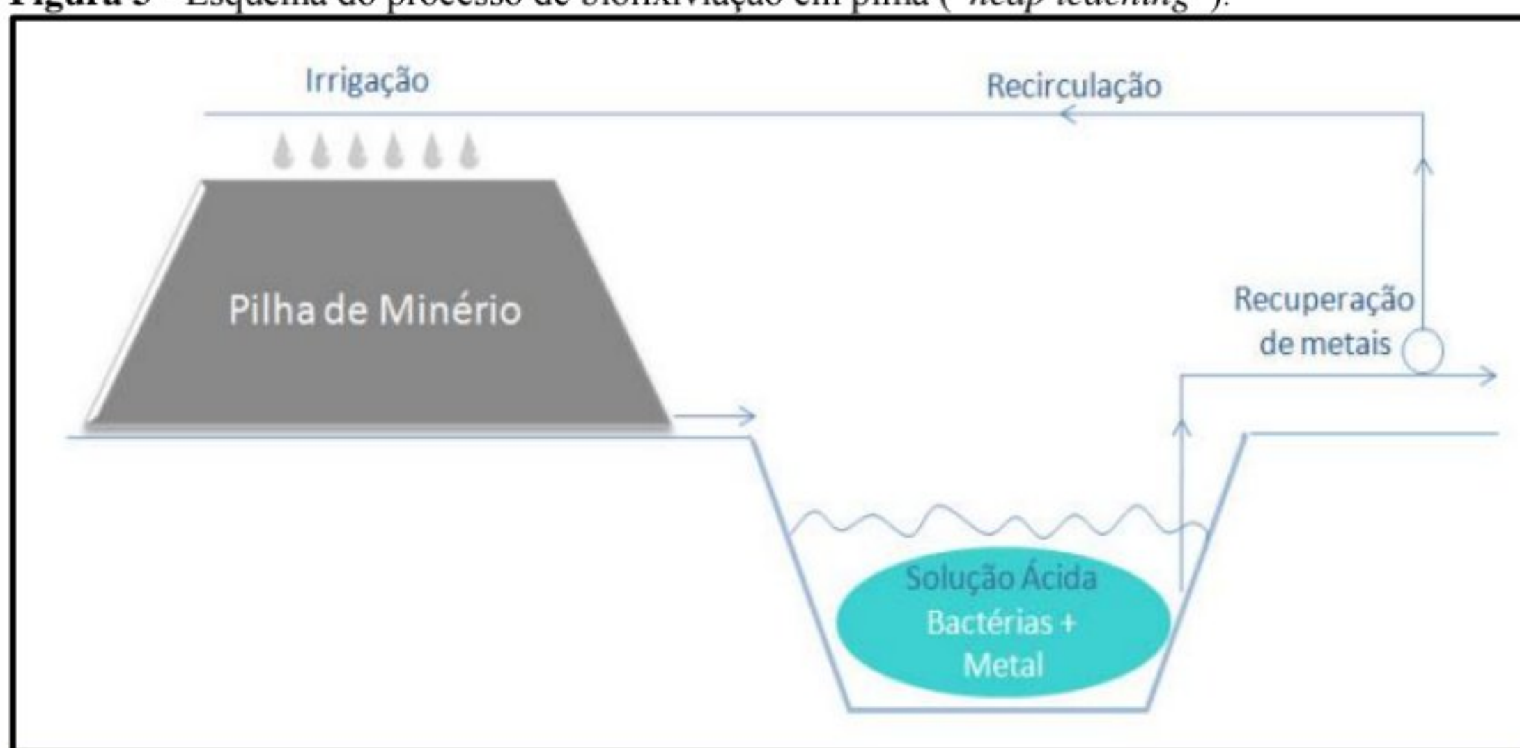
Figura 3 - Esquema do processo de biolixiviação em pilha (“ heap leaching ”).
