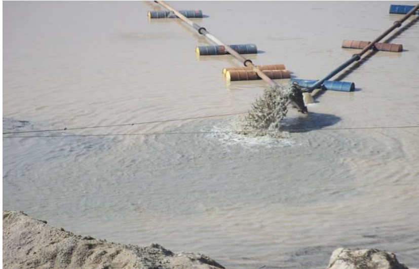
Figura 3 - Extração por meio de dragagem hidráulica.
