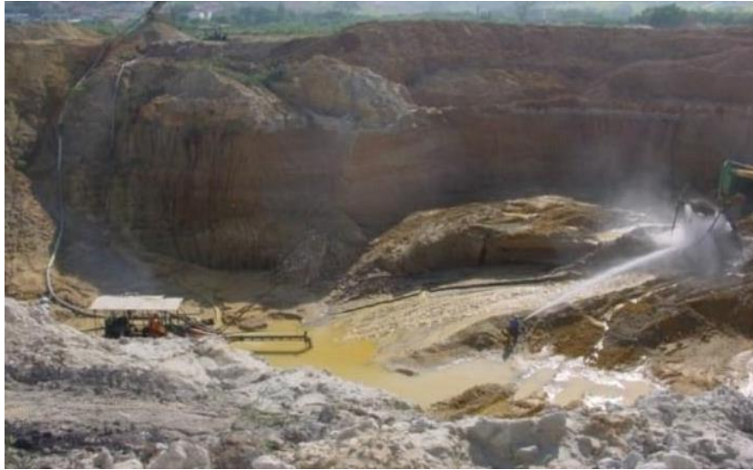
Figura 2 - Extração por desmonte hidráulico.
