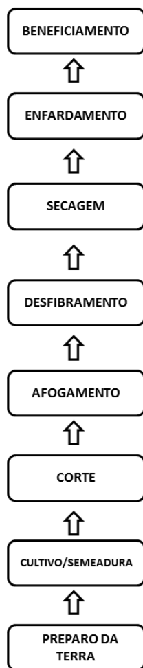
Figura 2: Esquema produtivo da fibra de juta
