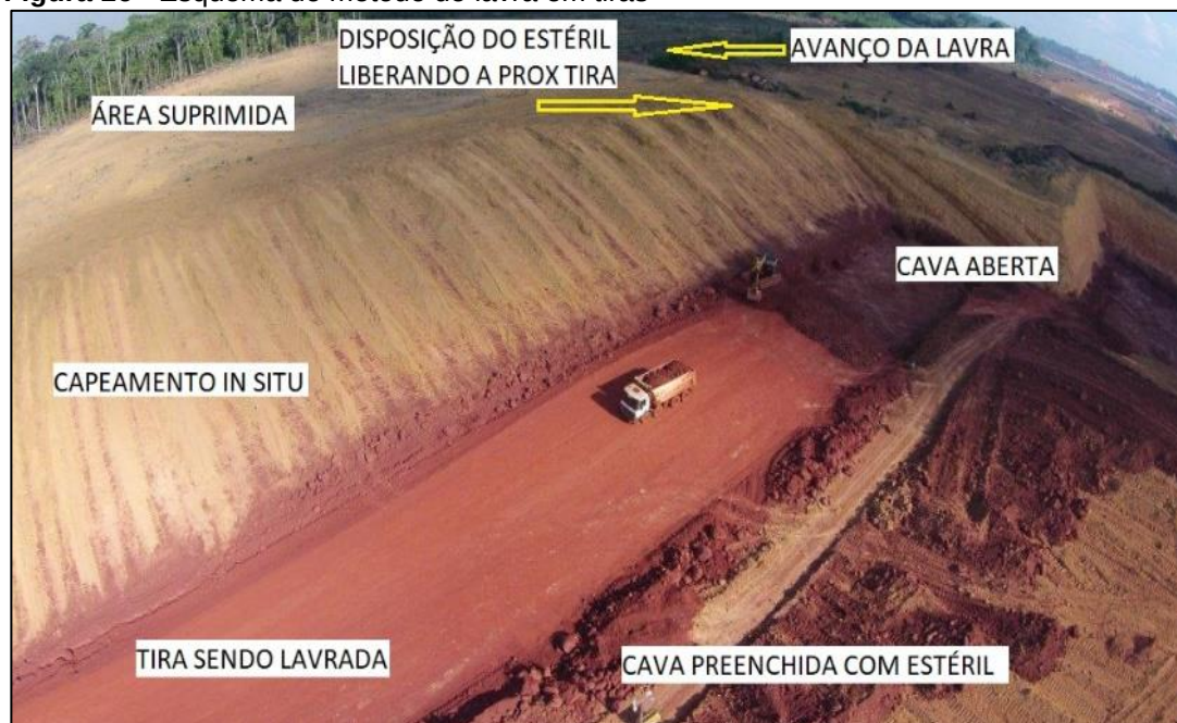
Figura 16 - Esquema do método de lavra em tiras
