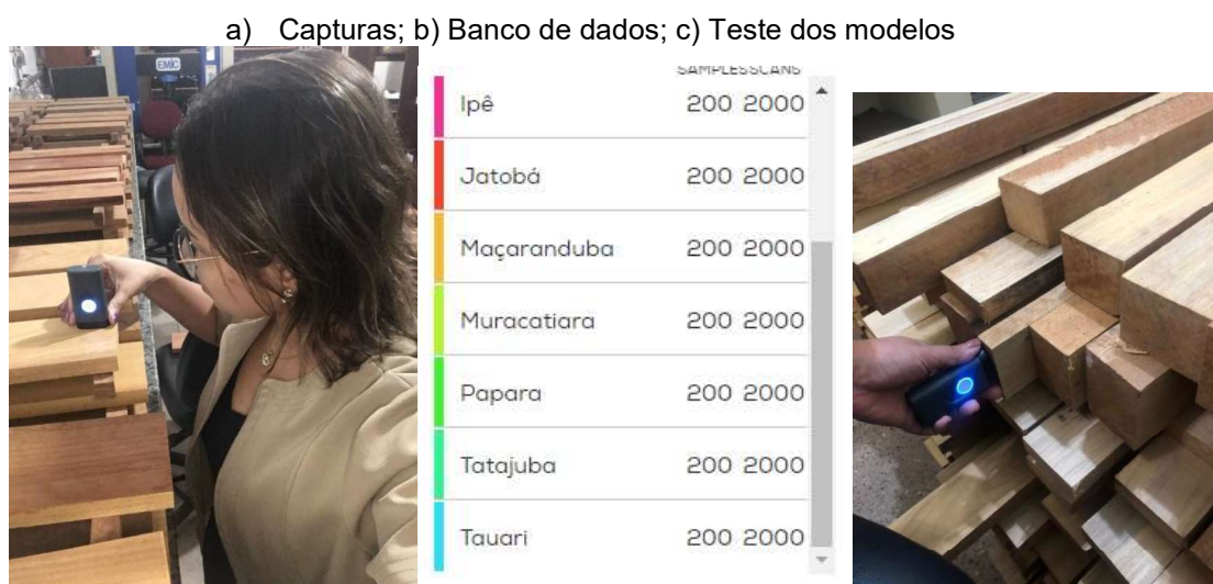
Figura 6: Processo de criação do projeto executado pela pesquisadora com SCiO Sensor.
