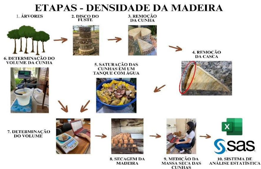
Figura 16 – Esquema metodológico para obtenção da densidade da madeira em diferentes níveis de umidade das árvores presente no sistema ILPF, Mojuí dos Campos, Pará.
