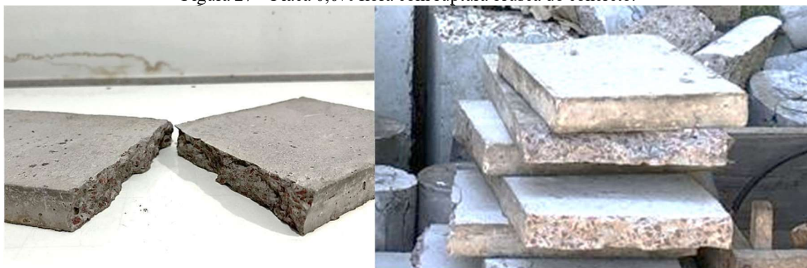
Figura 27 – Placa 0,0% fibra com ruptura brusca do concreto.
