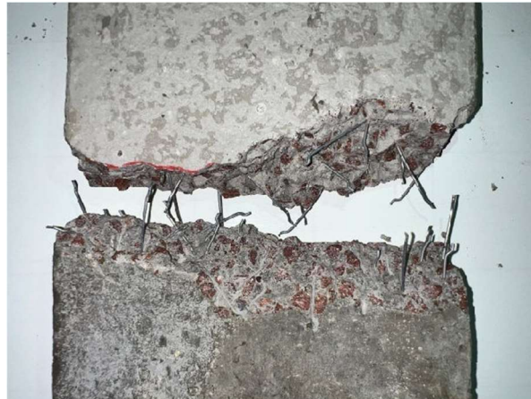
Figura 33 - Detalhamento da ancoragem das fibras PC3 1,0% fibras.
