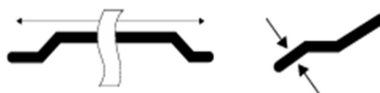
Figura 18 – Geometria das fibras de aço Tipo 2 – 3D Dramix 45/50 BN.
