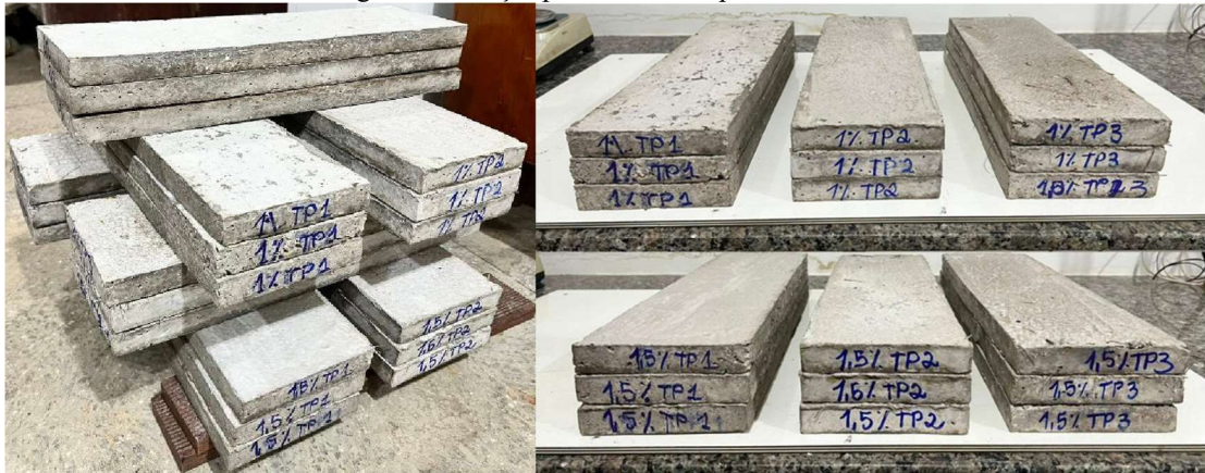
Figura 24 – Peças pré-moldadas após desformar
