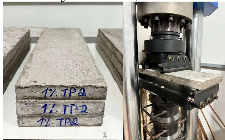
Figura 30 – Placas PC2 1,0% de fibras.
