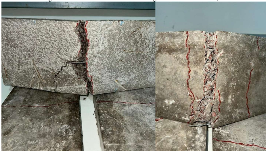
Figura 35 – Detalhamento de ancoragem das fibras PC3 1,5%.
