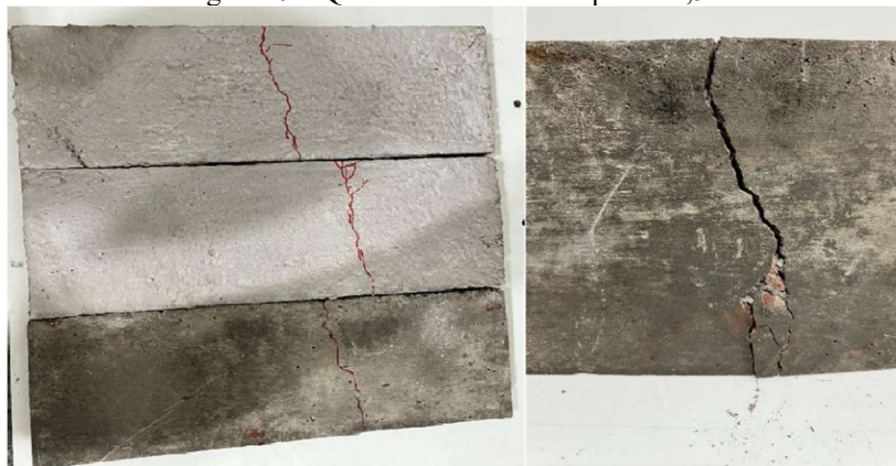
Figura 29 – Qualidade do concreto placas 1,5%.
