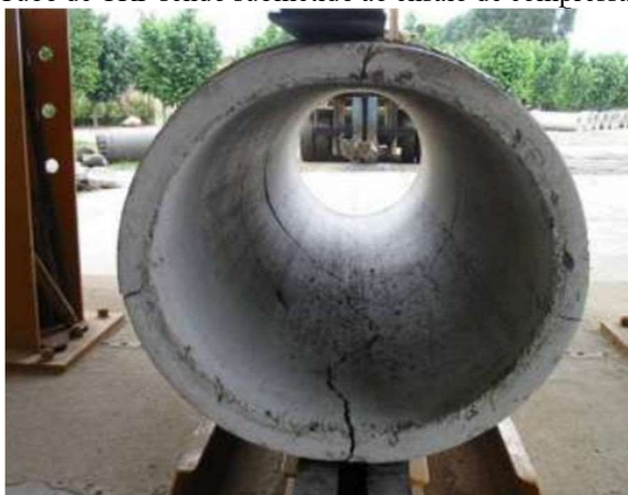
Figura 6 - Tubo de CRF sendo submetido ao ensaio de compressão diametral.
