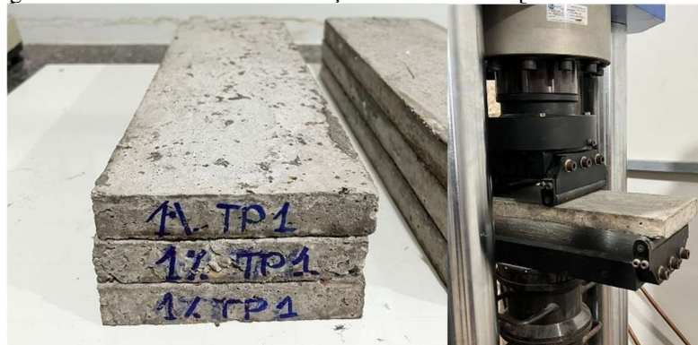
Figura 28 – Placas de concreto reforçadas com fibras Tipo 1 – Wiremix W40
