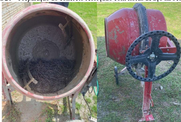
Figura 21 – Preparação do concreto reforçado com fibras de aço na betoneira.
