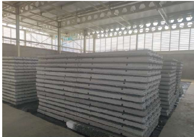
Figura 12: Pré- painéis montados na fábrica
