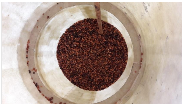
Figura 27 - Locação do meio filtrante.
