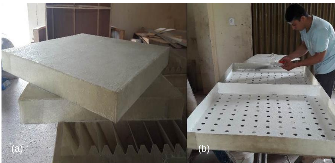
Figura 6 (a) e (b) - Confeção dos tabuleiros do aerador. Fonte: Direta.
