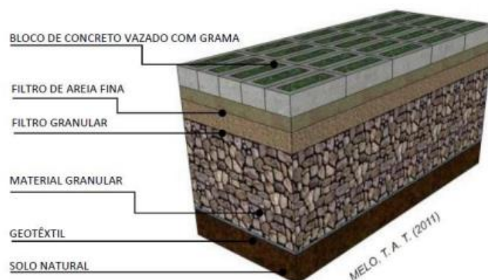
Figura 4 - Esquema construtivo de um pavimento semi-permeável.
