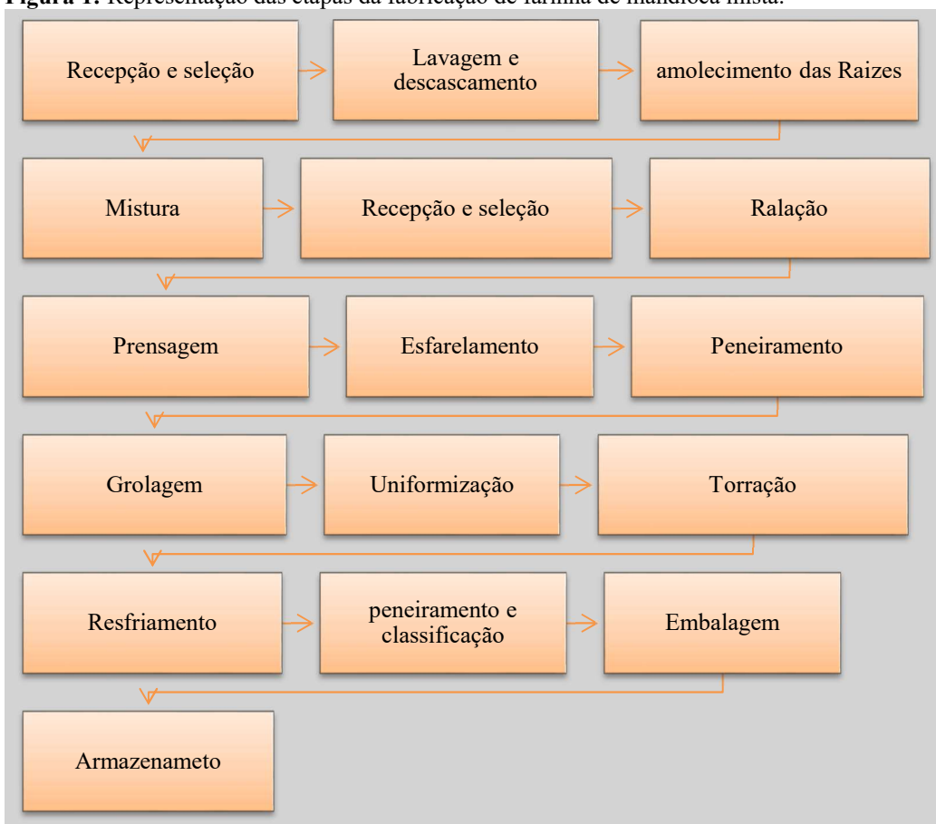
Figura 1: Representação das etapas da fabricação de farinha de mandioca mista.
