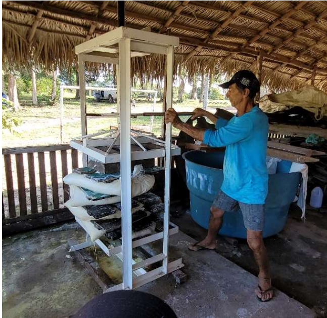
Figura 4: Extração do excesso de água da massa da mandioca através da prensa manual (parafuso).
