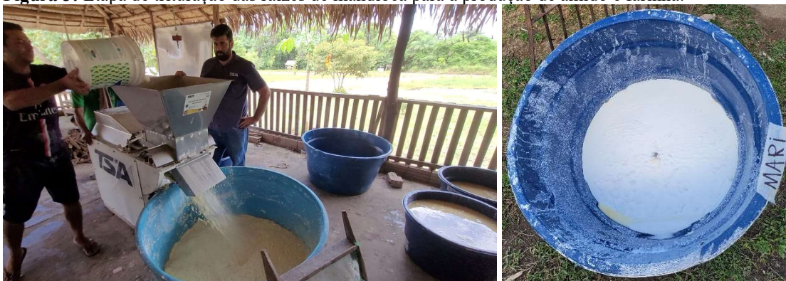
Figura 3: Etapa de trituração das raízes de mandioca para a produção de amido e farinha.
