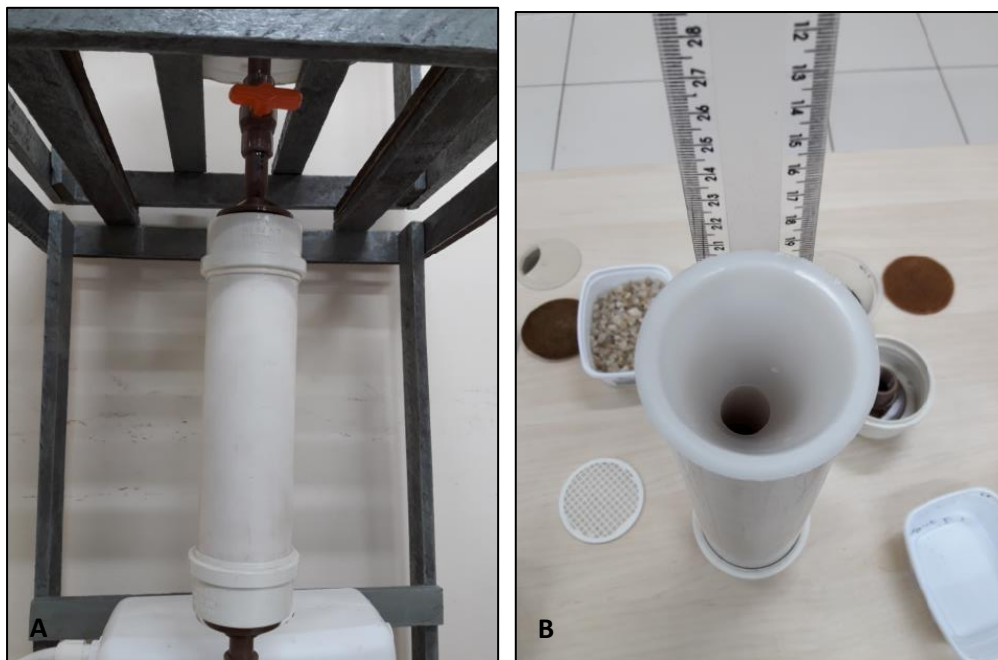
Figura 8 – (a) Filtro instalado, (b) Medição das camadas do filtro
