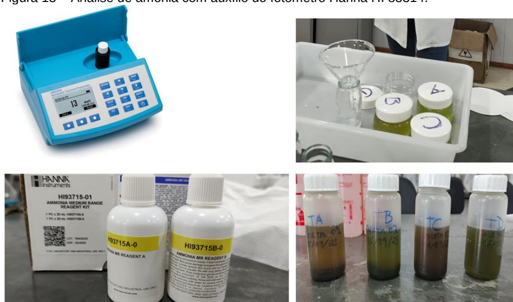
Figura 13 – Análise de amônia com auxílio do fotômetro Hanna HI 83314.
