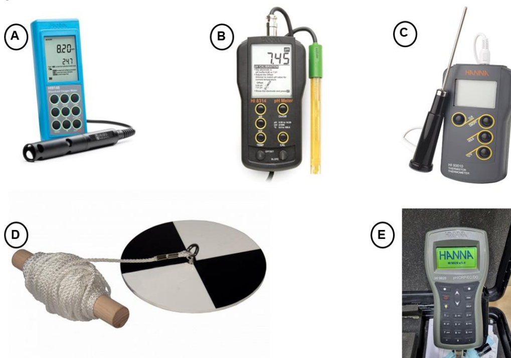
Figura 12 – a) medidor de oxigênio dissolvido Hanna HI9146; b) medidor de pH Hanna HI8314; c) medidor de temperatura Hanna HI93510; d) disco de secchi; e) medidor de turbidez Hanna modelo HI9828.
