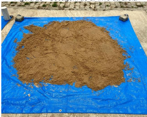
Figura 25 - Secagem ao ar livre da areia
