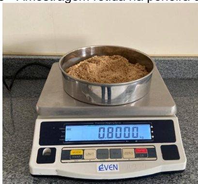
Figura 26 - Amostragem retida na peneira de 0,3 mm
