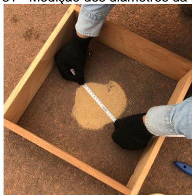
Figura 31 - Medição dos diâmetros da mancha
