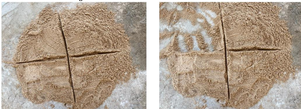
Figura 24 - Quarteamento de amostra de areia
