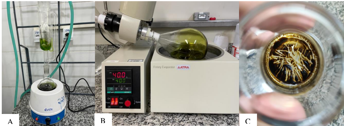
Figura 7. Etapas de extração do EELD. A) Extração por Soxhlet. B) Evaporação do solvente. C) Extrato etanólico de L. dulcis bruto.
