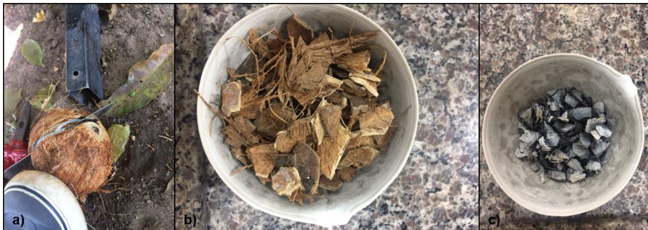
Figura 8 – Produção de Carvão ativado a partir de endocarpo de coco.
