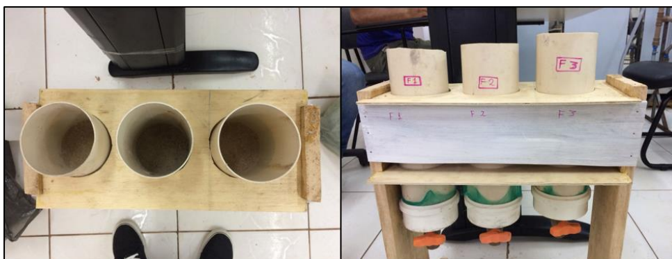
Figura 11 - Produção da base do protótipo de filtro
