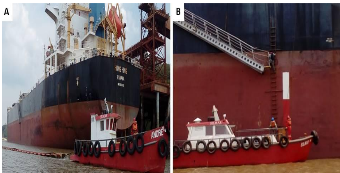
Figura 12 - Atracação do navio no porto. A) lançamento de barreira de contenção. B) agente marítimo subindo a bordo do navio.
