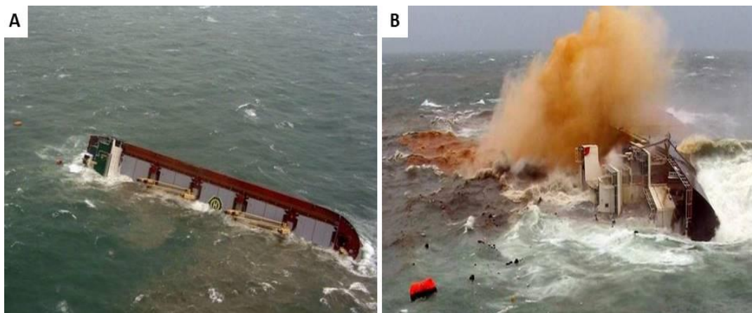
Figura 31 - Navios naufragados devido a liquefação. A) Navio de Hong Kong B) Trans Summer
