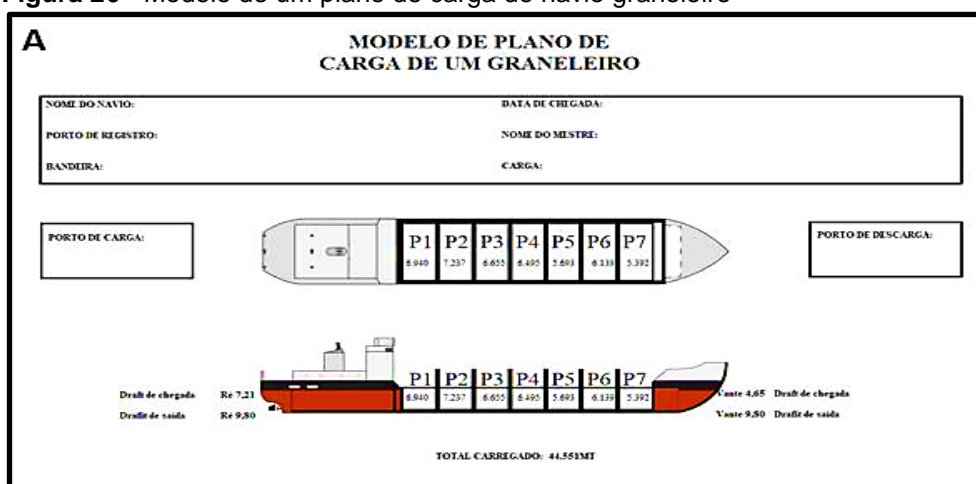
Figura 26 - Modelo de um plano de carga de navio graneleiro
