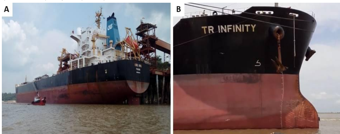
Figura 11 - Atracação do navio no porto. A) Navio atracado B) Leitura do calado de boreste (lado direito) da proa (frente) do navio
