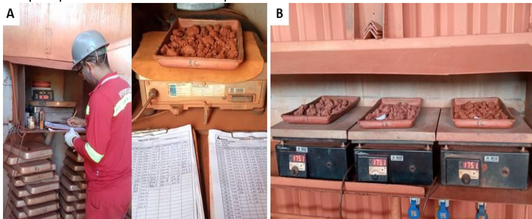
Figura 21 - Secagem de amostras. A) Colaborador fazendo as anotações em planilha B) Chapa aquecedora com amostras dispostas
