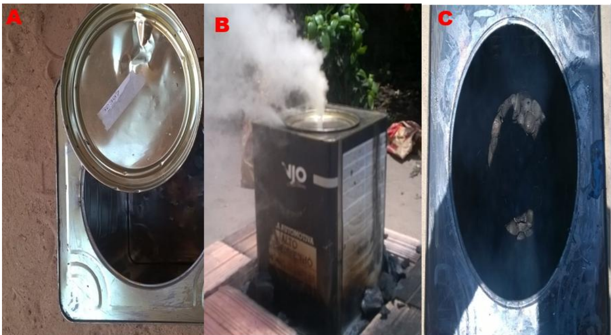
Figura 10: A- Recipiente de 18L; B- Processo de Carbonização; - C- Caroço de Tucumã já carbonizado.
