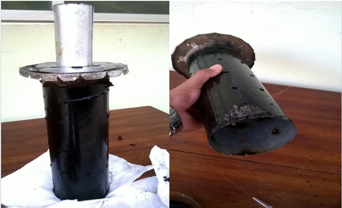
Figura 27: Filtro contendo em sua estrutura o composto químico (alcatrão). Fonte: Direta.
