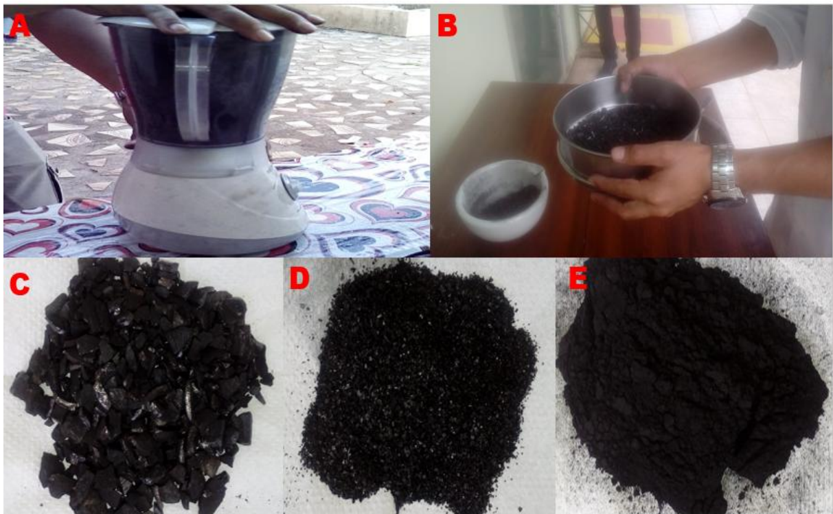
Figura 11: A-Trituração no Liquidificador; B- Peneiração do Carvão na peneira MESH; C- Carvão com granulometria >18\mu\text{m} ; D- Carvão com granulometria >50\mu\text{m} ; E- Carvão com granulometria 200 \mu\text{m} . Fonte: Este estudo.
